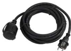
1-OS. KUMIJATKOJOHTO 20 M H07RN-F 3 x 1,5 mm 2
