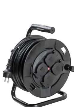
JATKOJOHTOKELA 4-OS. 20M IP44 H05RR-F 3 x 1,5 mm 2
