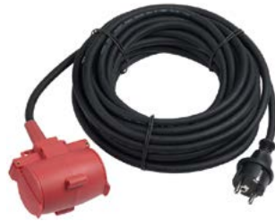
2-OS. KUMIJATKOJOHTO 3X2,5MM 2 10M Tynnyripää-haaroin H07RN-F 3 x 2,5 mm 2
