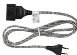
1-OS. EUROJATKOJOHTO 2M KANGASJOHTO H03VVH2-F 2 x 0,75 mm 2
