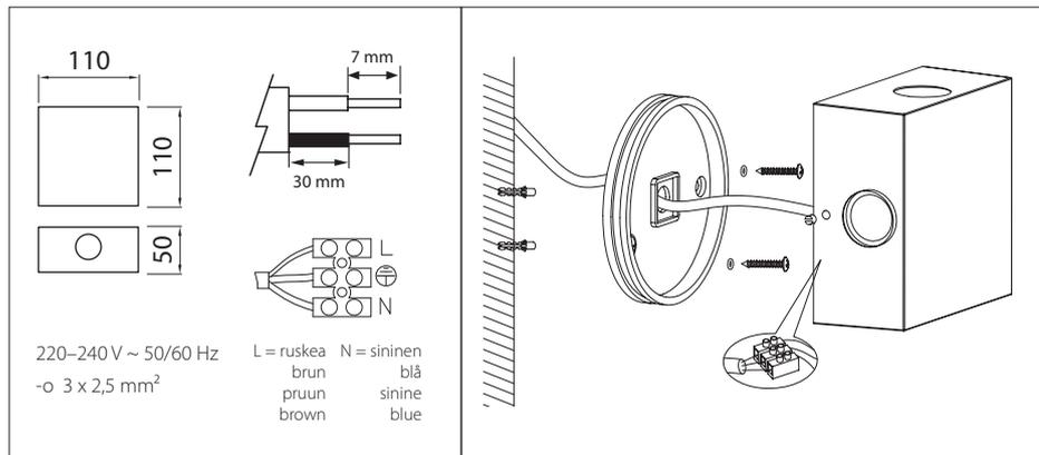
Valaisimen saa asentaa vain sähköalan ammattilainen. Käytä ainoastaan syöttöjännitettä ja taajuutta joka on merkitty liitântälaitteeseen. Kytke virta pois päältä ennen asennusta tai huoltoa. Valonlähdeä ei voi vaihtaa. Vaihda tilalle uusi valaisin, jos valonlähde rikkoutuu. Tämä asennusohje on säilytettävä ja sen on oltava käytössä asennuksessa ja huollossa.
