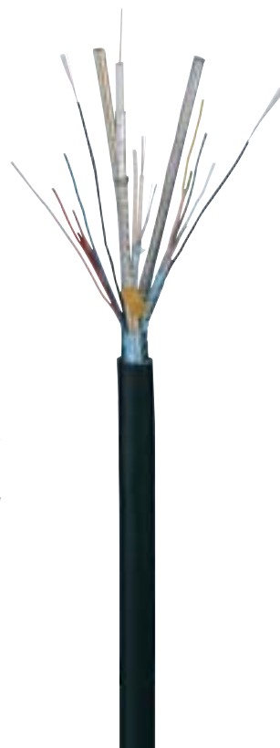
Prod.-Nr. 1720 Kamerakabel Camera cable 3 x 0,6/2,7 C (F) + Li09Y (PiMF) 1 x 2 x 0,48 mm 2 + Li2Y 3 x 2 x 0,14 mm 2 ALF + Li2Y 3 x 2 x 0,14 mm 2 ALF – PVC
