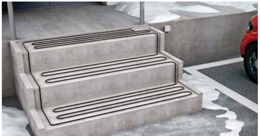
Tash-vakiovastus-kaapelin asennus tehdään aina lenkiksi ja johdin vietään aina takaisin rasiaan kylmäkaapelilla. (KUVA OHJEELLINEN)
