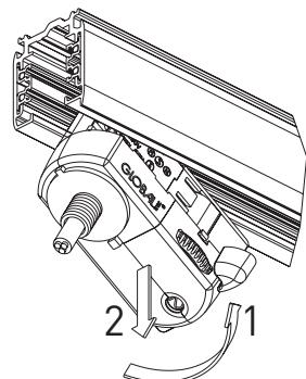
Vaiheet (1, 2 tai 3) voidaan valita ennen virran ottolaitteen kiinnitystä kiskoon tai kiinnitettyä.
