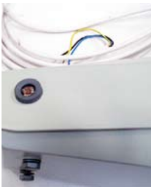
Kuva yllä esittää erikoisvarusteltua valaisinta, jossa hämäräkytkin.
